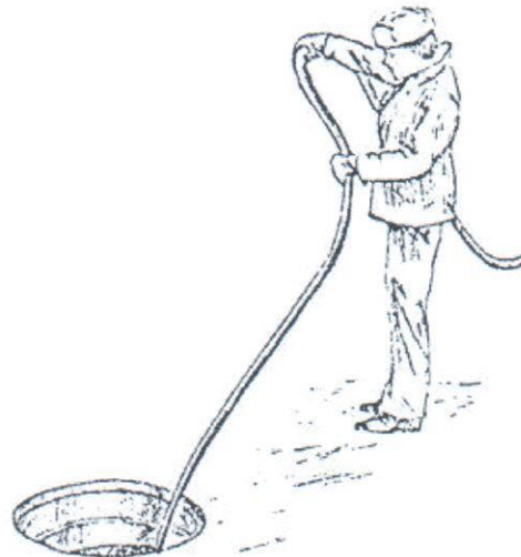
Рис.6. Прокручивание трубы при прокладке по каналу кабельной канализации.
