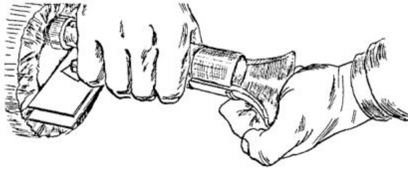
Рис. 12. Установка направляющей воронки на полиэтиленовую трубу.
