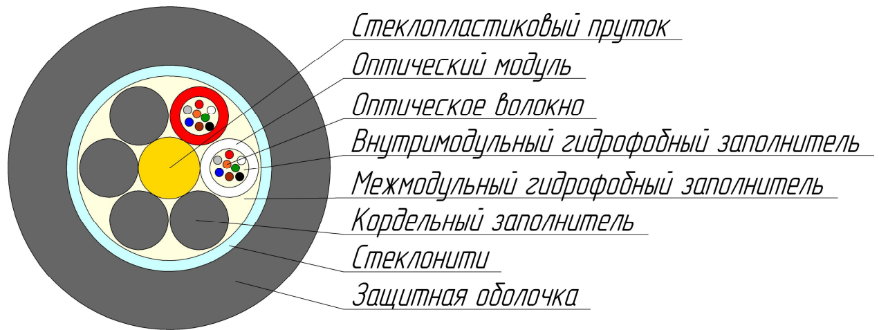
Рис. 1б. Конструктивное исполнение кабеля ОКГ-II вариант исполнения с упрочняющими нитями
