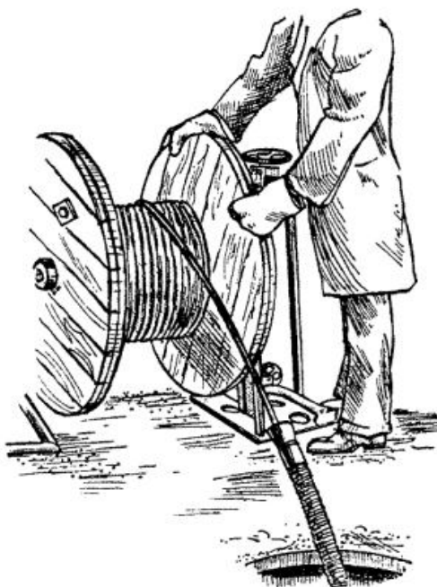
Рис. 15. Размотка кабеля с барабана во время прокладки.
