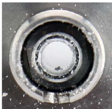
Верхняя часть загрязненного торца коннектора
