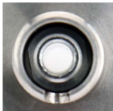
Верхняя часть очищенного торца коннектора
